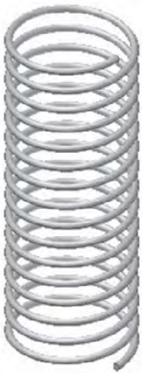
Figura P3-6: figura construida en MMGS se debe elegir por parte del diseñador el plano de trabajo que más información proporcione para la construcción de la pieza. Dibuja la siguiente primavera. Diámetro =2.00 Diámetro del alambre = 0.125 Paso= 0.375
