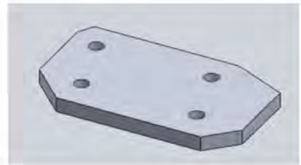
Figura P1-6: la figura debe construirse en MMGS y una Extrusión de 10 MM.
